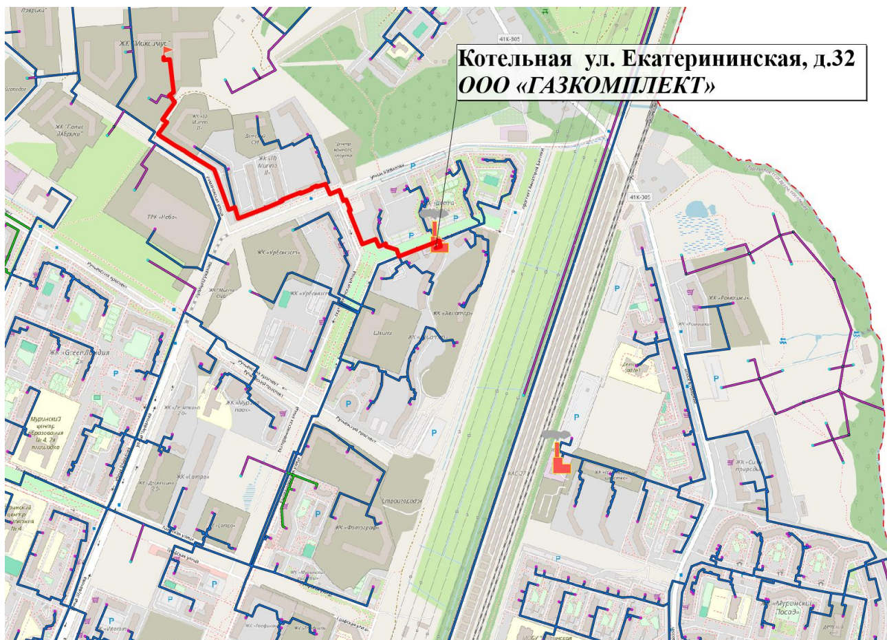
Рисунок 27. Путь для построения пьезометрического графика от котельной ООО «ГАЗКОМПЛЕКТ» Екатеринбургская 32, стр.1 до перспективного потребителя
