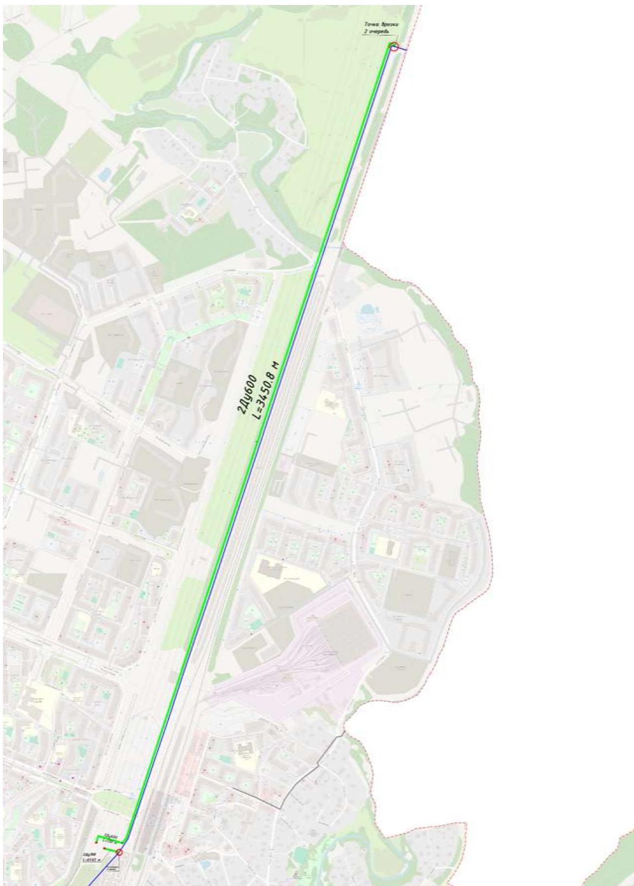
Рисунок 12. Вариант подключения 2 -ой очереди ТПУ «Девяткино» от тепломагистрали Суздальская Северная ТЭЦ-21 ПАО «ТГК-1»
