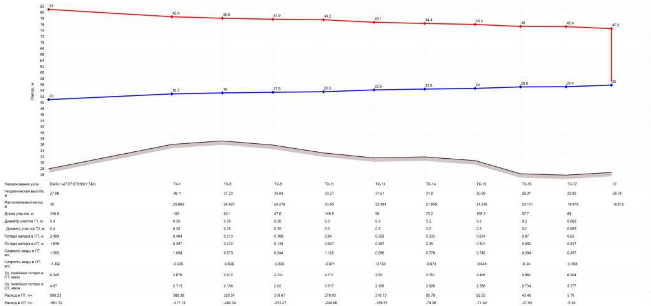
Рисунок 36. Пьезометрический график участка тепловой сети от БМК-1 (ТК «Мурино») до перспективного потребителя
