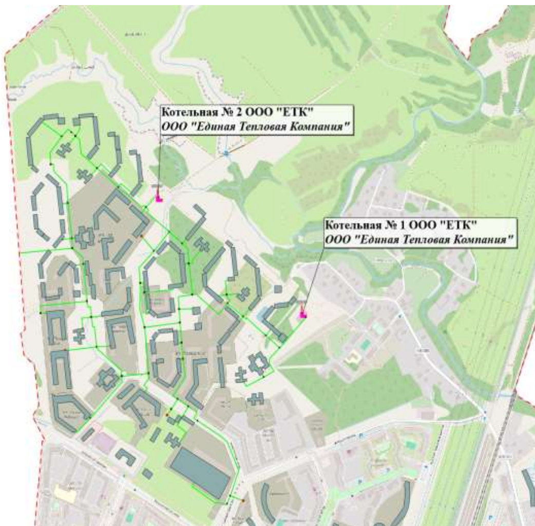
Рисунок 31. Путь для построения пьезометрического графика от котельной №1 (ООО «ЕТК») до перспективного потребителя
