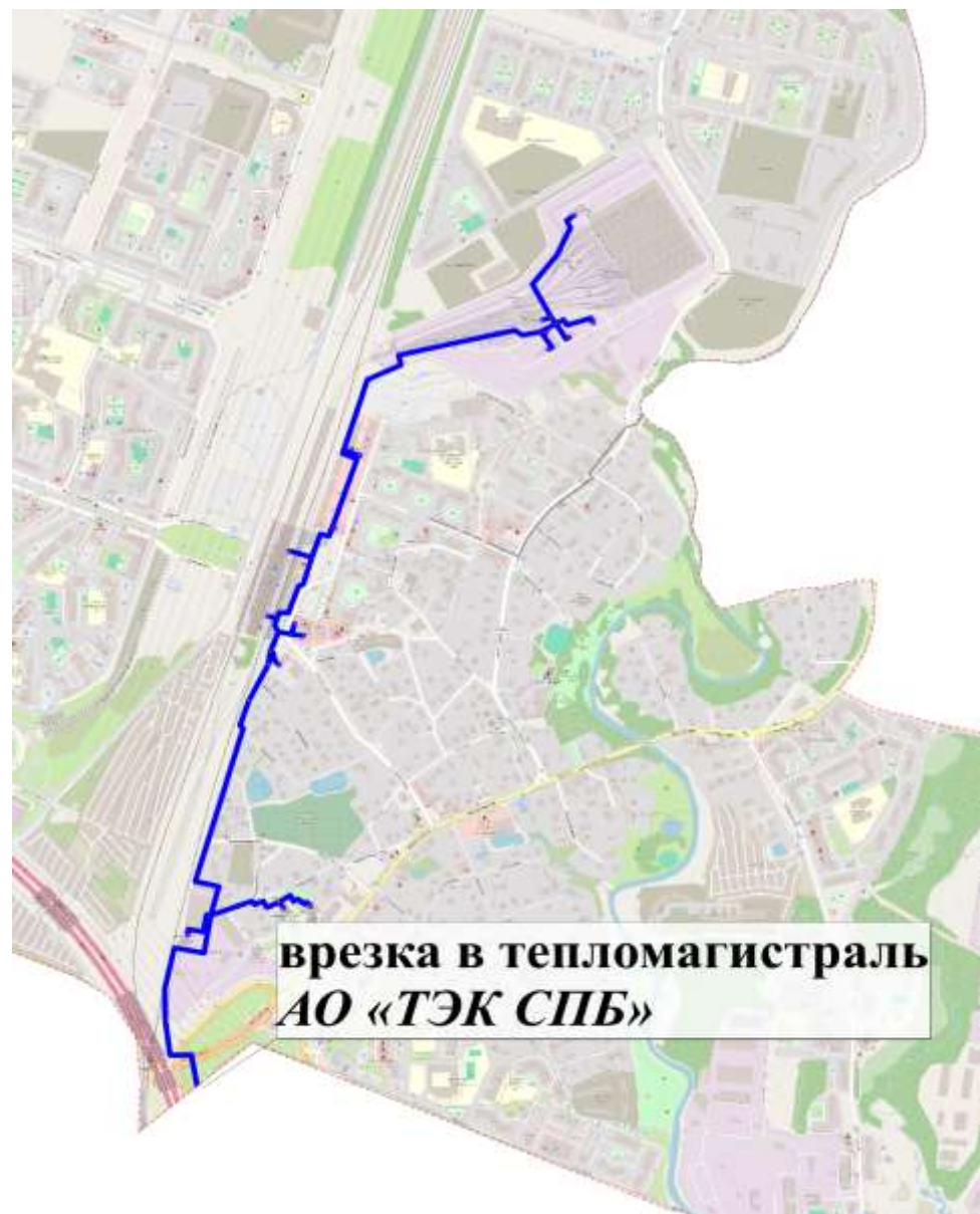
Рисунок 11. Схема тепловых сетей котельной «Северомуринская» АО «ТЭК СПб» на территории Муринского ГП
