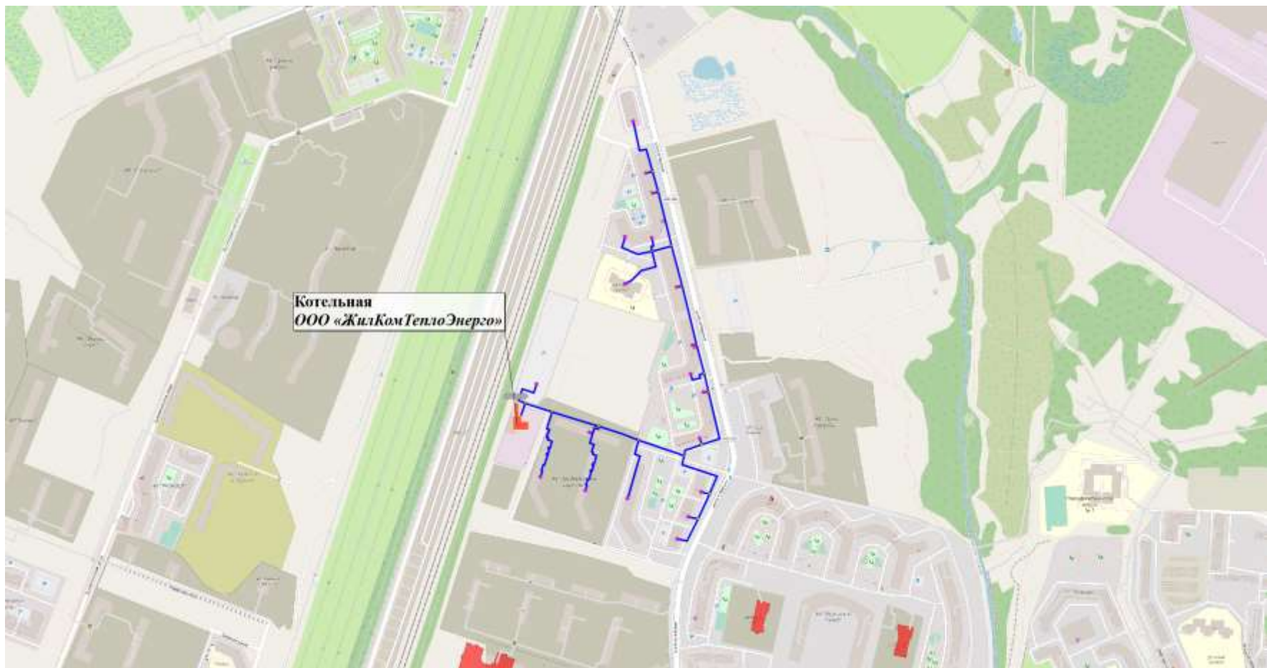
Рисунок 6. Схема тепловых сетей котельной ООО «ЖилКомТеплоЭнерго»
