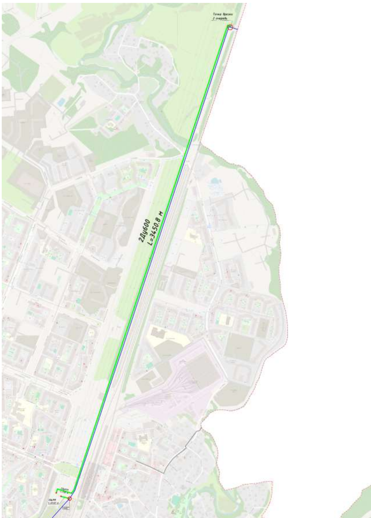
Рисунок 39. Вариант подключения 2-ой очереди ТПУ «Девяткино» от тепломагистрали Суздальская Северная ТЭЦ-21 ПАО «ТГК-1»
