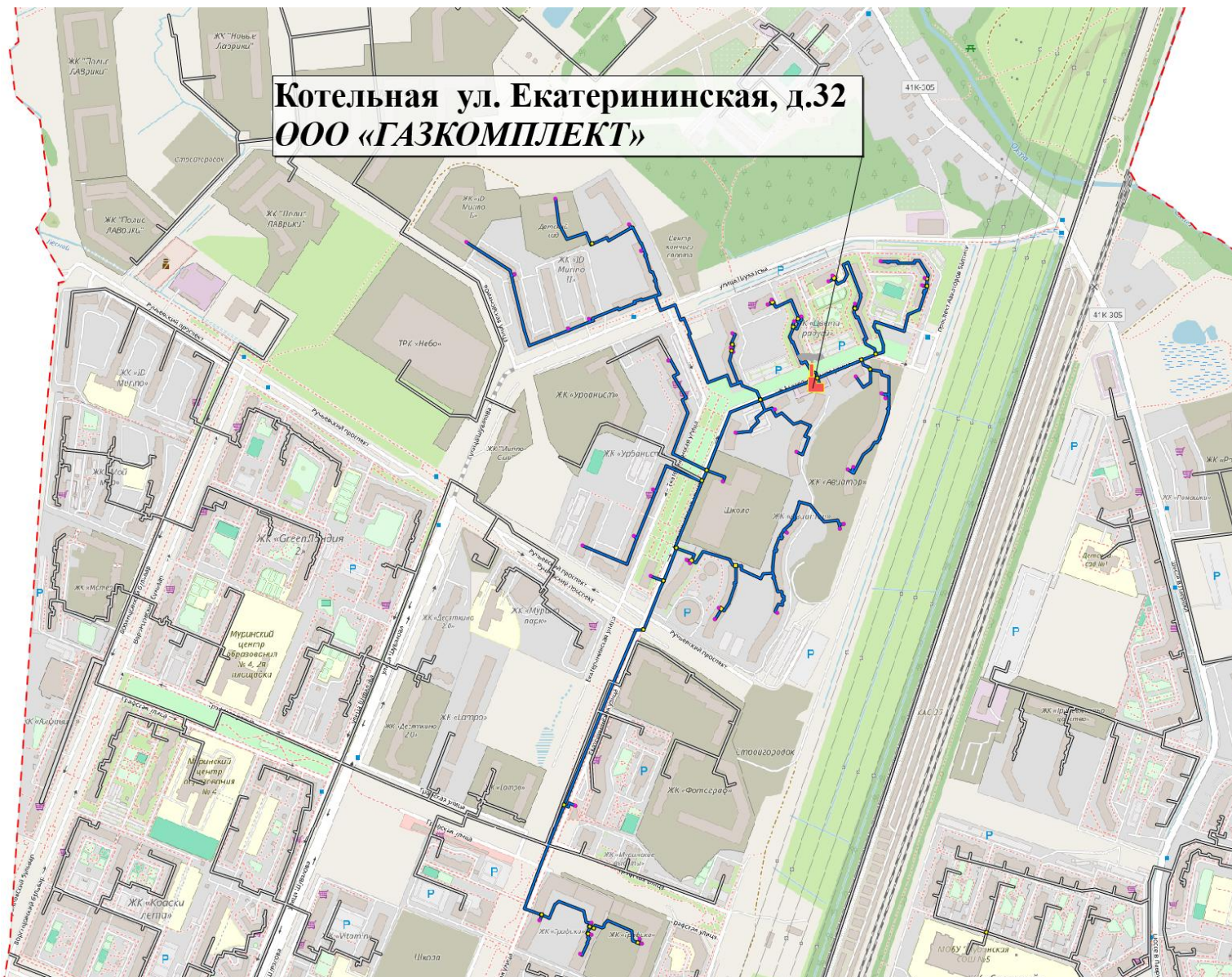
Рисунок 10. Схема тепловых сетей котельной ООО «ГАЗКОМПЛЕКТ» ул. Екатерининская, л. 32, стр. 1
