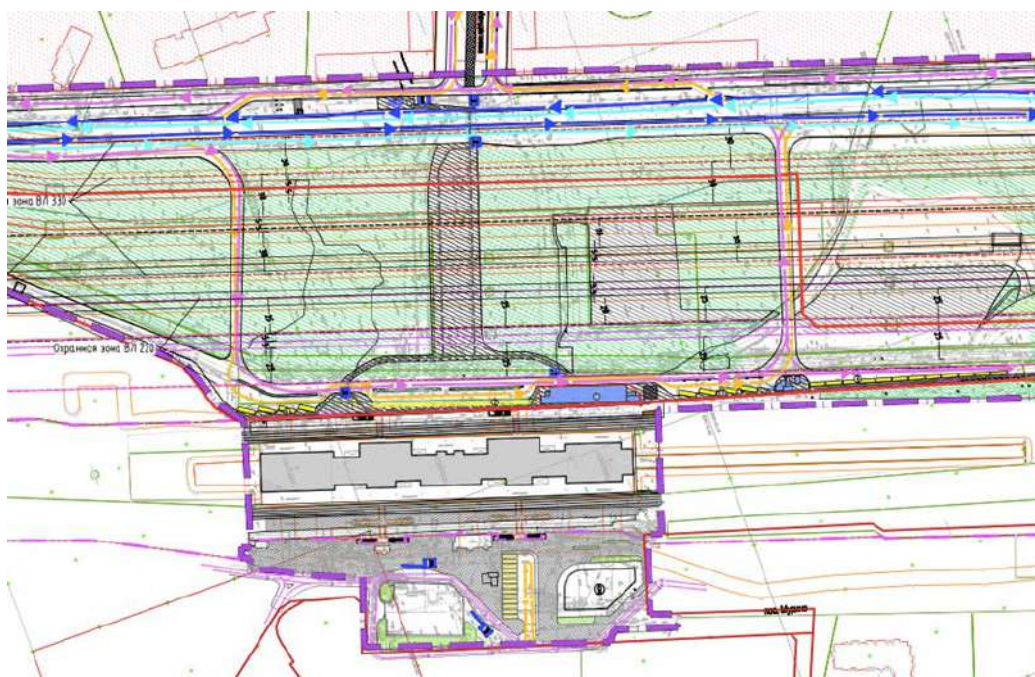
Рисунок 2.2.6.2 - Схема строительства ТПУ "Девяткино" (крупный план)
