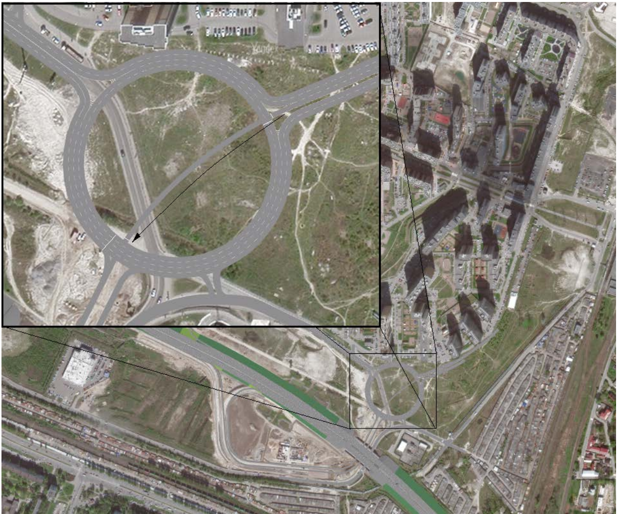
Рисунок 4.2.6.1 – Вариант ОДД на пересечении ал. Охтинская – пр-т Авиаторов Балтики
