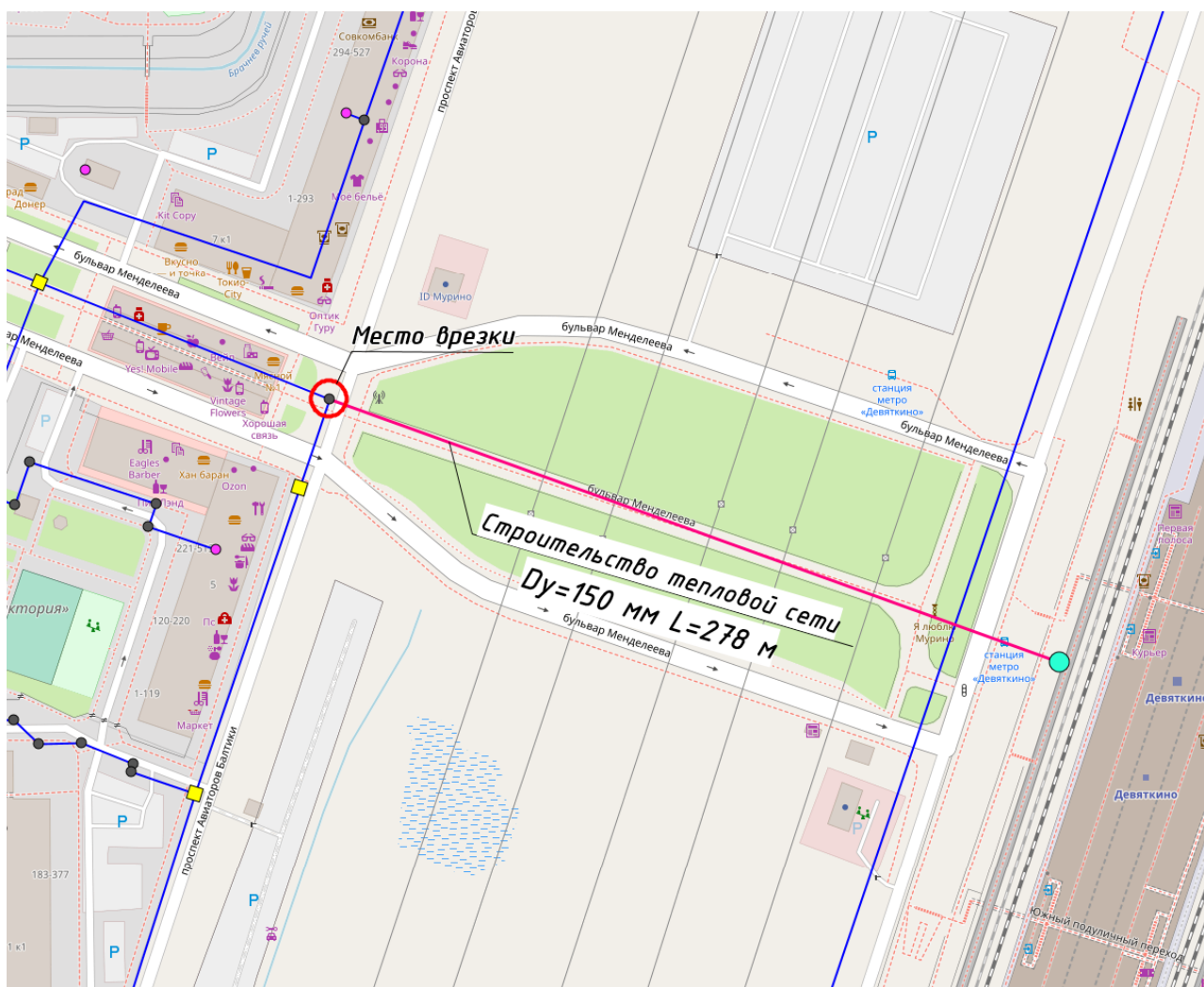
Рисунок 36. Вариант подключения ТПУ «Девяткино» от существующих тепловых сетей ООО «Петербургтеплоэнерго»
