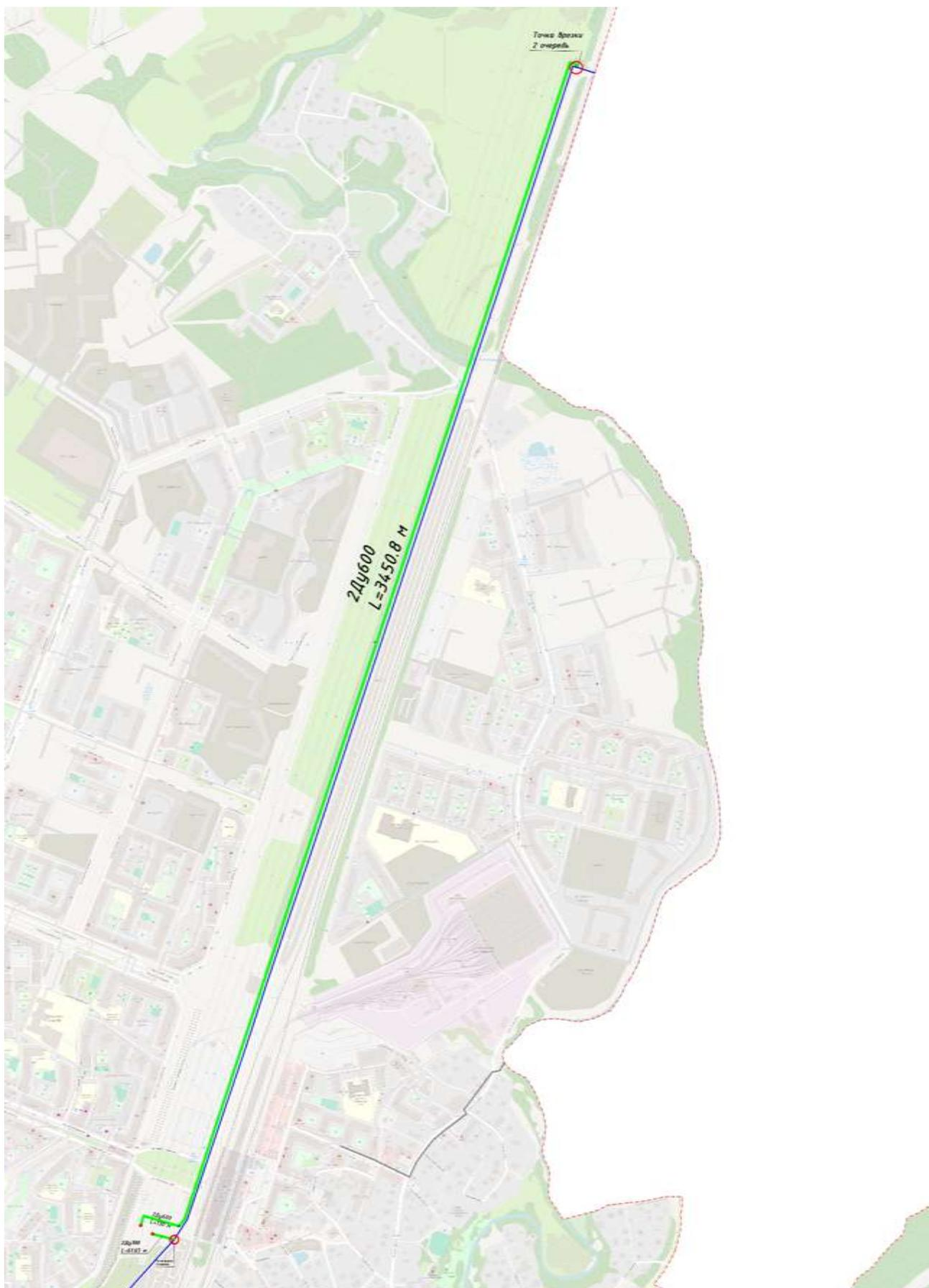
**Рисунок 12. Вариант подключения 2-ой очереди ТПУ «Девяткино» от тепломагистрали Суздальская Северной ТЭЦ-21 ПАО «ТГК-1»**
