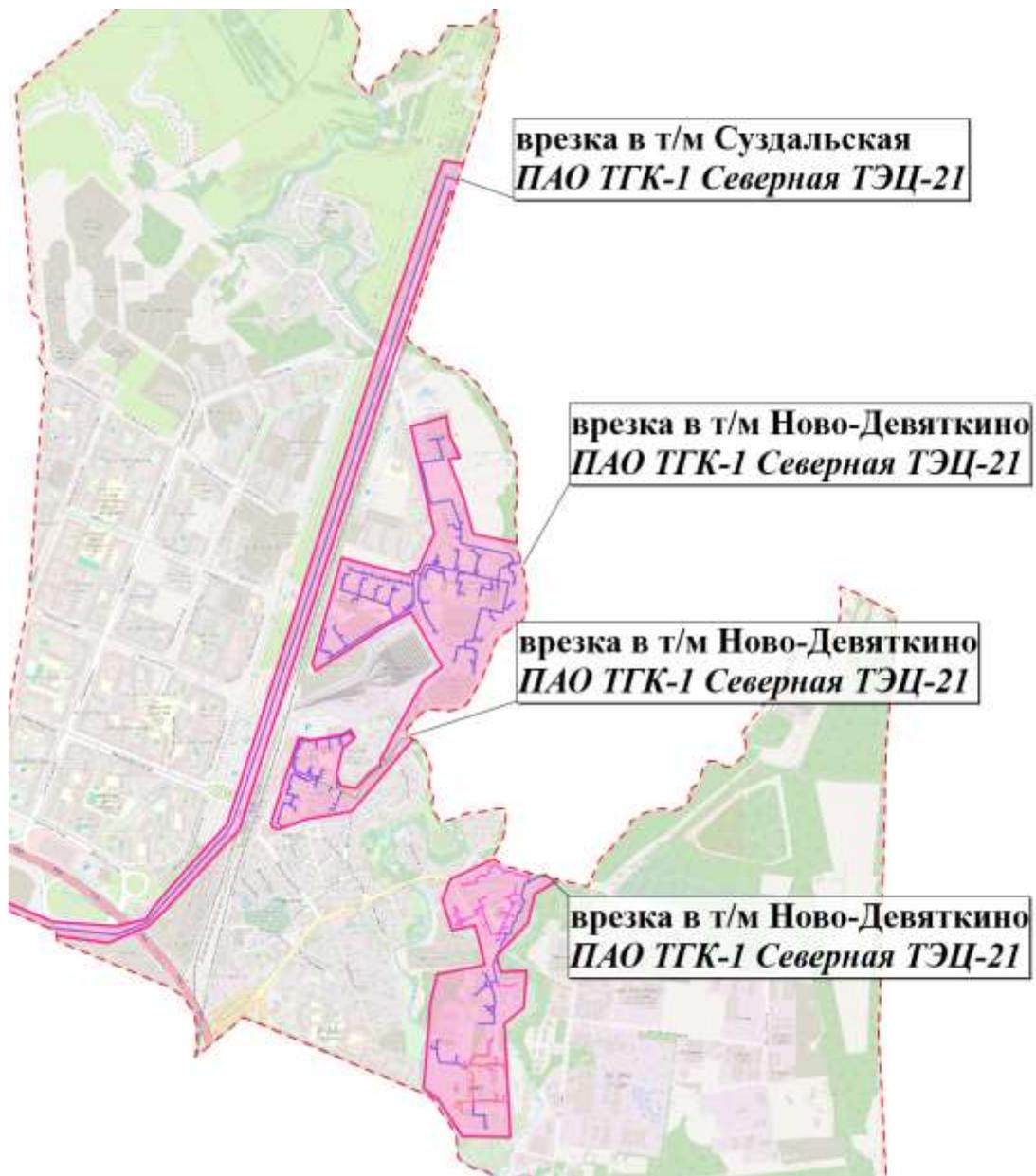
**Рисунок 4. Зона действия источника теплоснабжения Северная ТЭЦ-21 ПАО «ТГК-1» (на территории Муринского ГП)**
