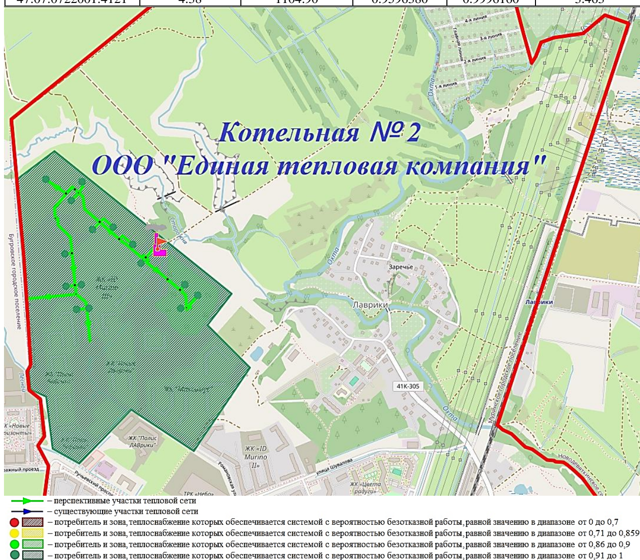
Рисунок 8. Зона, характеризующая надежность теплоснабжения потребителей котельной ЕТК-2 ООО «Единая тепловая компания» на период до 2030 года в границах муниципального образования «Муринское городское поселение»
