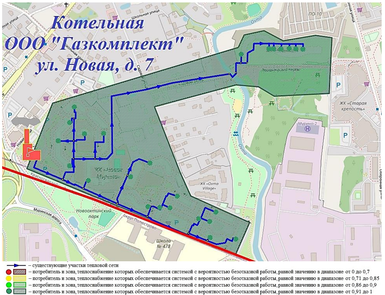
Рисунок 42. Зона, характеризующая надежность теплоснабжения потребителей котельной ООО «Газкомплект» (ул. Новая д.7) в границах МО «Муринское городское поселение»
