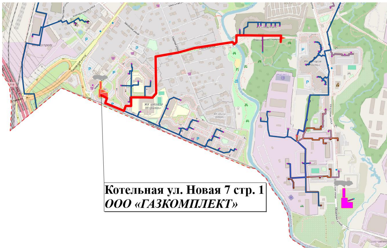
Рисунок 29. Путь для построения пьезометрического графика от котельной ООО «ГАЗКОМПЛЕКТ» ул. Новая, д. 7 до перспективного потребителя ДОУ на 260 мест
